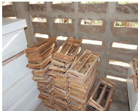
Figure 12: Cadres pour les ruches Langstroth © AOUDJI Augustin
